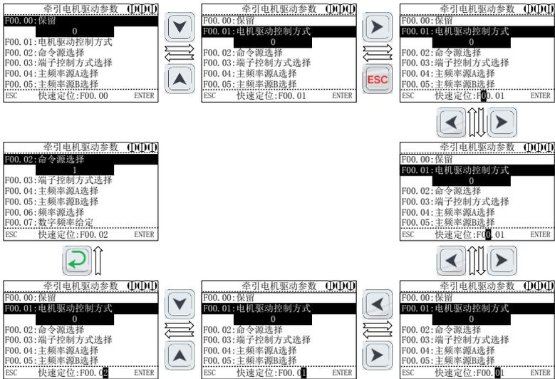
图 4-5 驱动器参数设置模式下功能码的查看和快速定位
